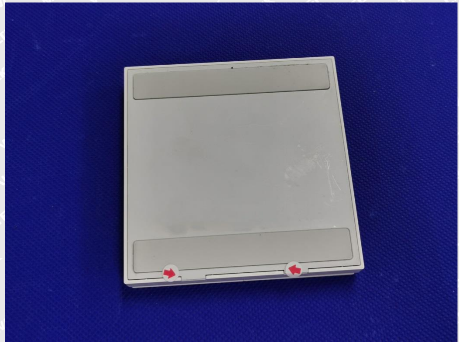
EN 61000-4-2 Test View
