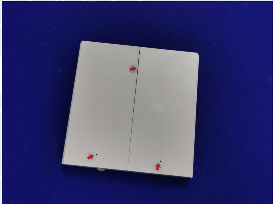
EN 61000-4-2 Test View
