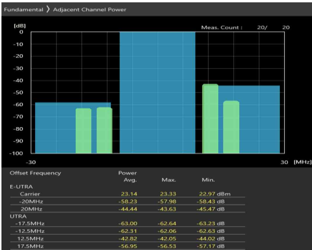
Band20 16QAM BW=20MHz Channel=24300 RB Size=100 Position=#
