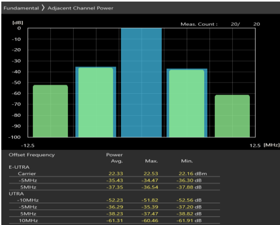
Band20 QPSK BW=10MHz Channel=24200 RB Size=12 Position=#0
