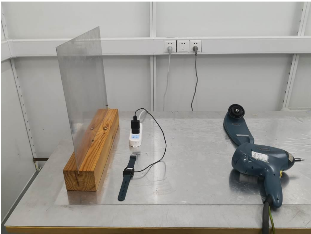
EN 61000-4-2 ESD TEST SETUP
