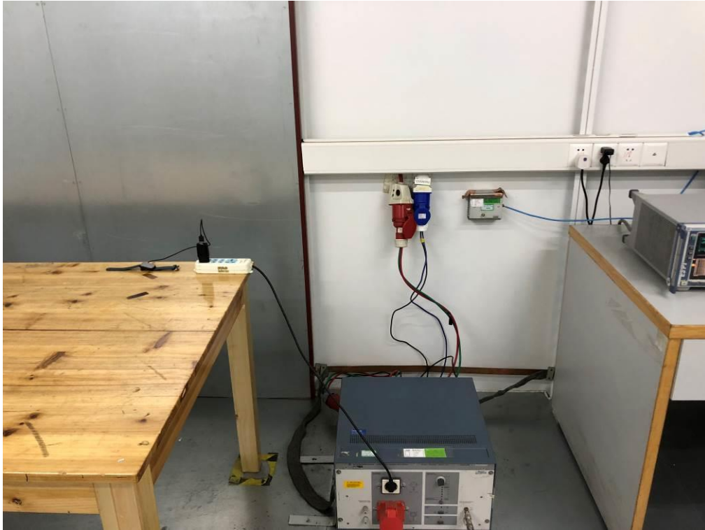
EN 61000-4-2 ESD TEST SETUP
