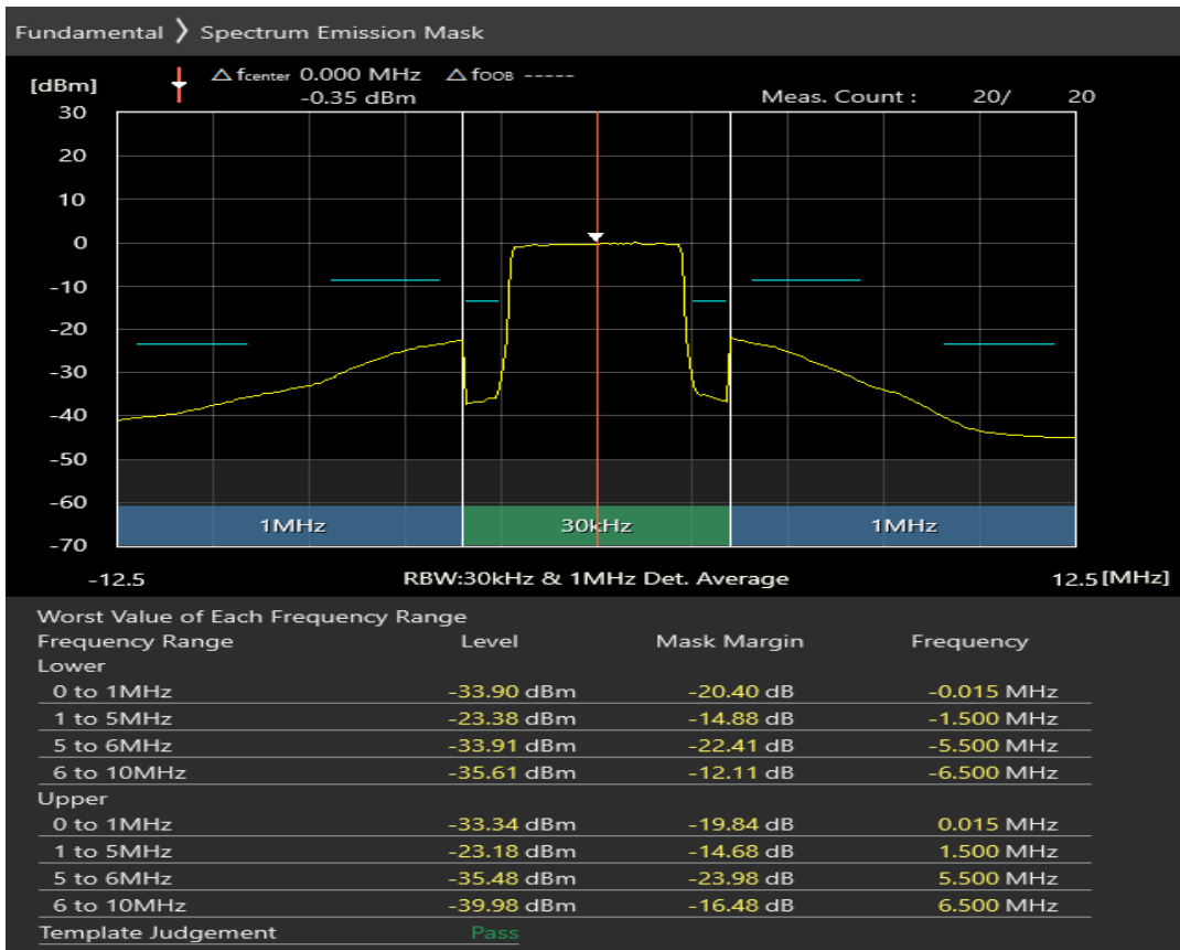
Band20 QPSK BW=10MHz Channel=24200 RB Size=12 Position=#0
