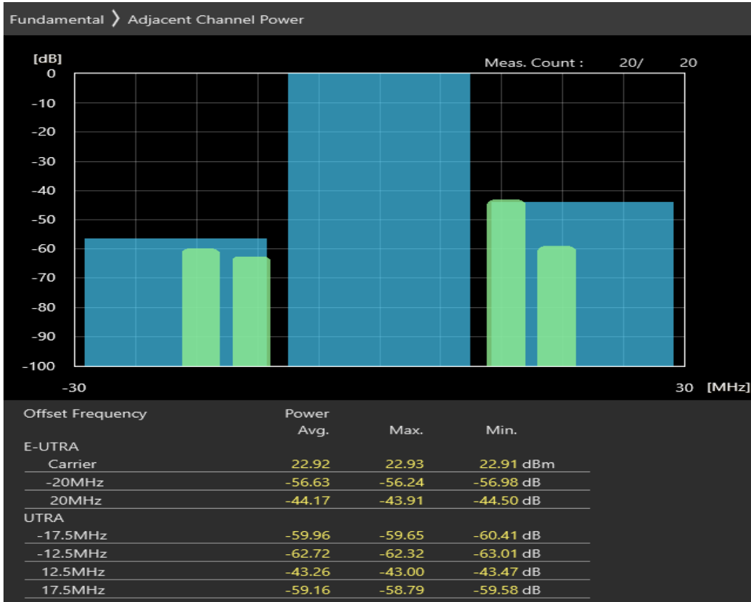
Band20 QPSK BW=20MHz Channel=24300 RB Size=100 Position=#0
