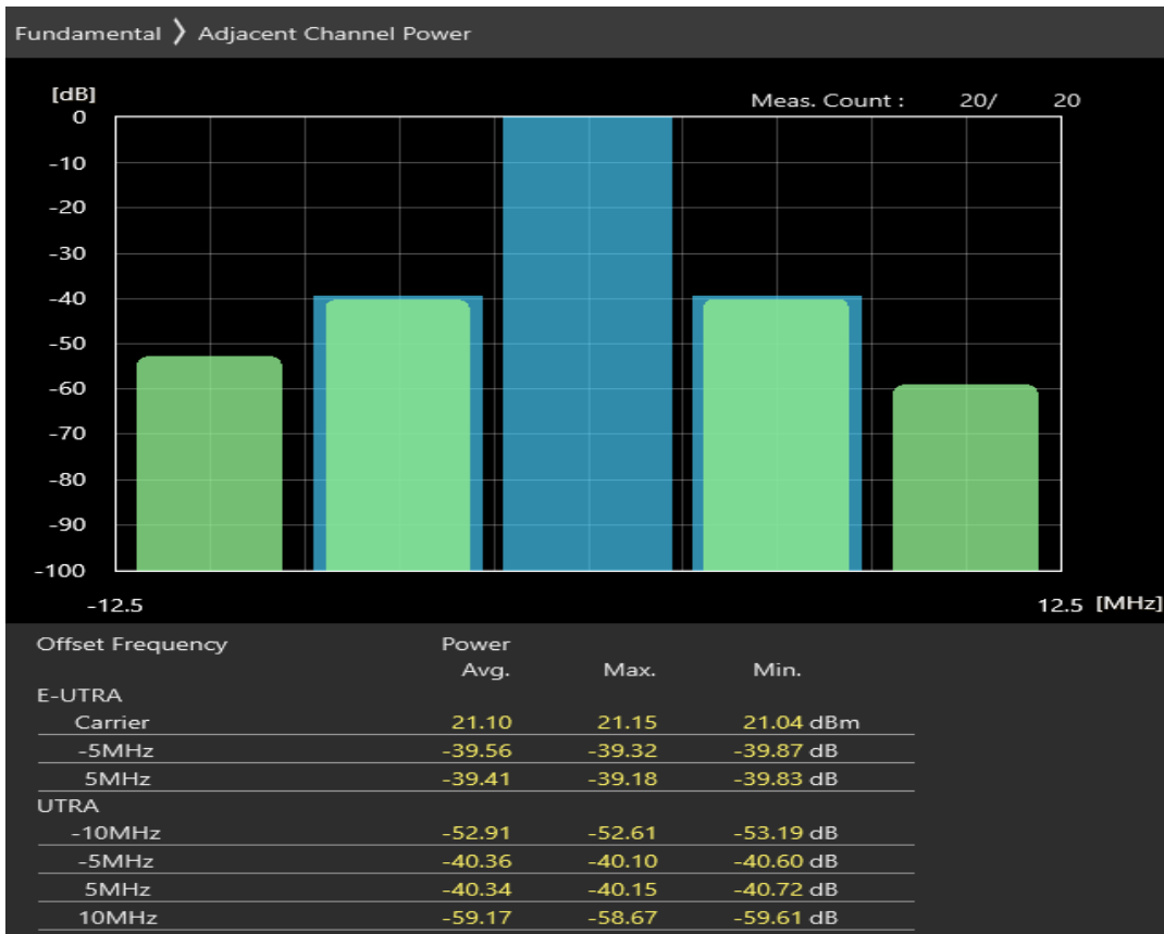
Band20 QPSK BW=10MHz Channel=24200 RB Size=12 Position=#0
