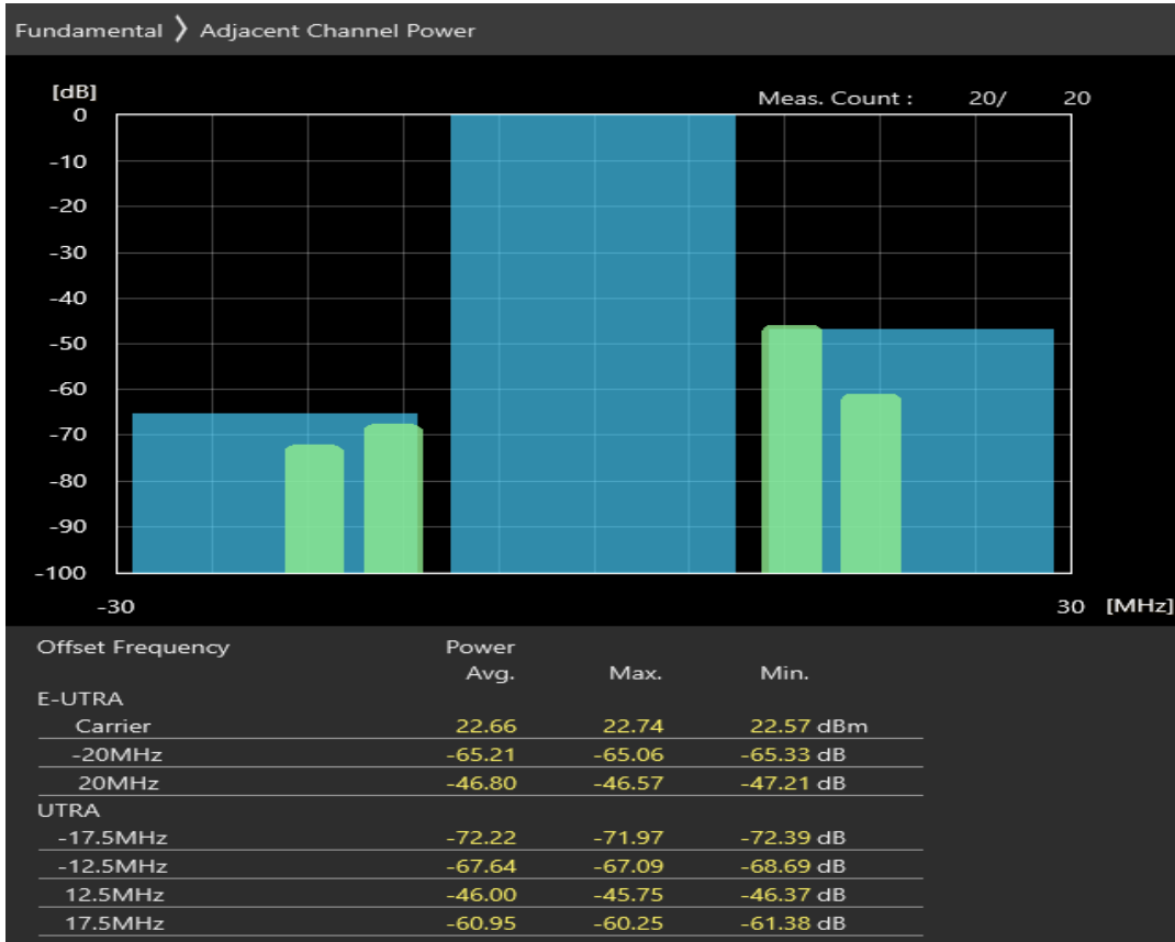
Band20 16QAM BW=20MHz Channel=24250 RB Size=100 Position=#0
