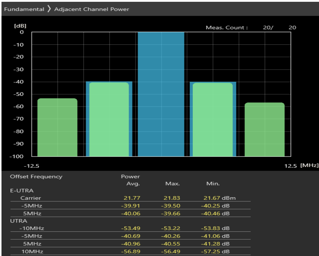
Band20 QPSK BW=10MHz Channel=24200 RB Size=12 Position=#0
