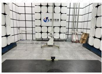
**RADIATED EMISSION TEST above 1G**
